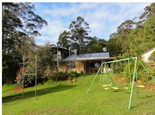
自宅:ソーラーパネルの右後方の円筒は雨水の揚水タンク
